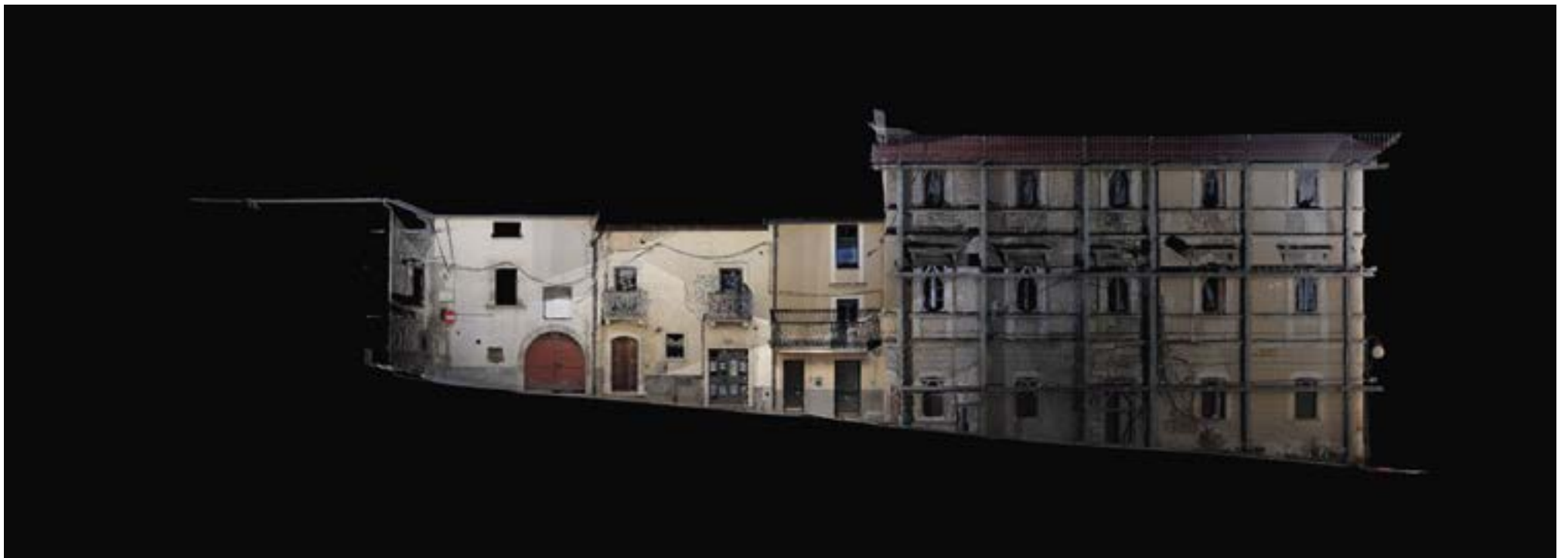
Rilievi strumentali dei prospetti esterni con Laser Scanner 3D
